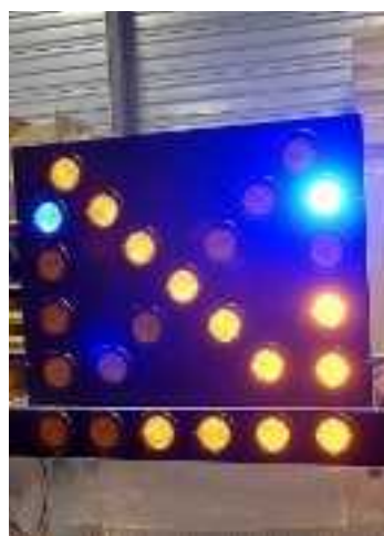
Les flèches de rabattement bénéficient aussi de la technologie leds.
